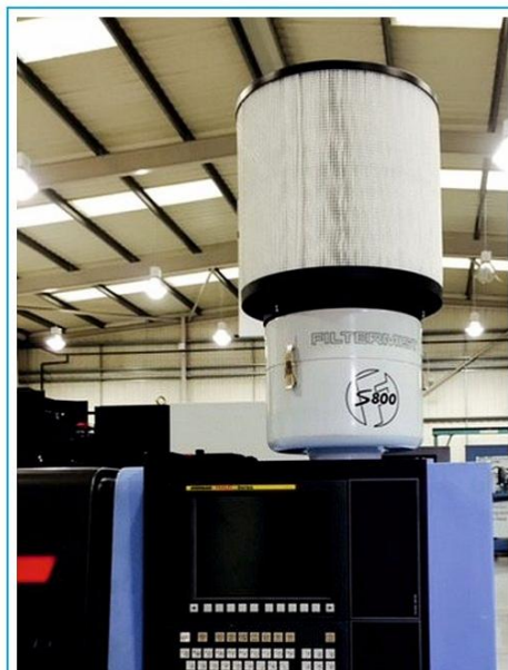
nahore: běžný HEPA filtr, uprostřed: vysokokapacitní věžový EPA/HEPA filtr, dole: mikrovláknový filtr s drenáží a dlouhou životností
